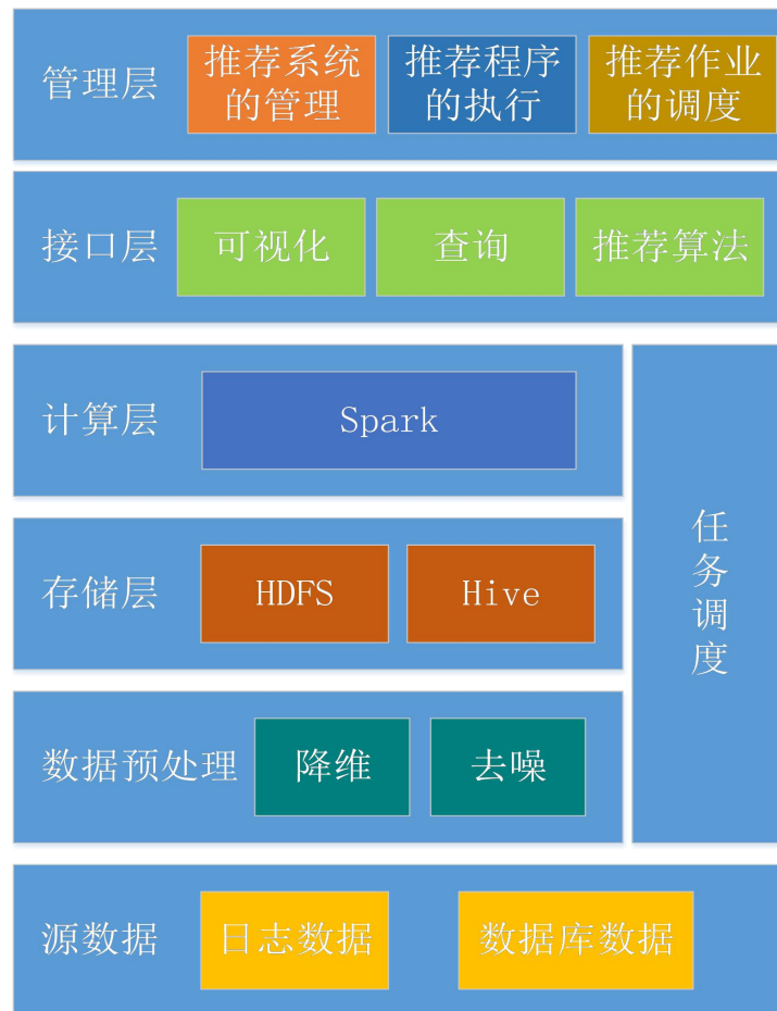
图 3 融合评分和评论的推荐系统架构图
