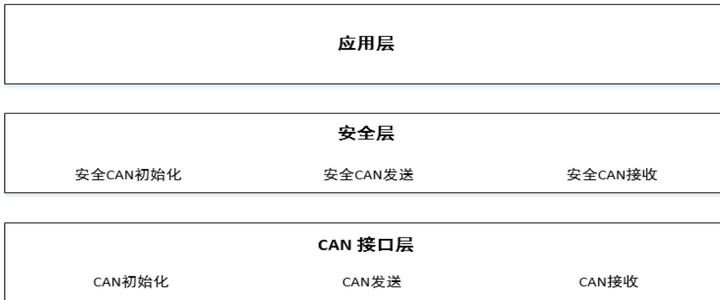
图 3.5 安全 CAN 总线协议的软件架构
