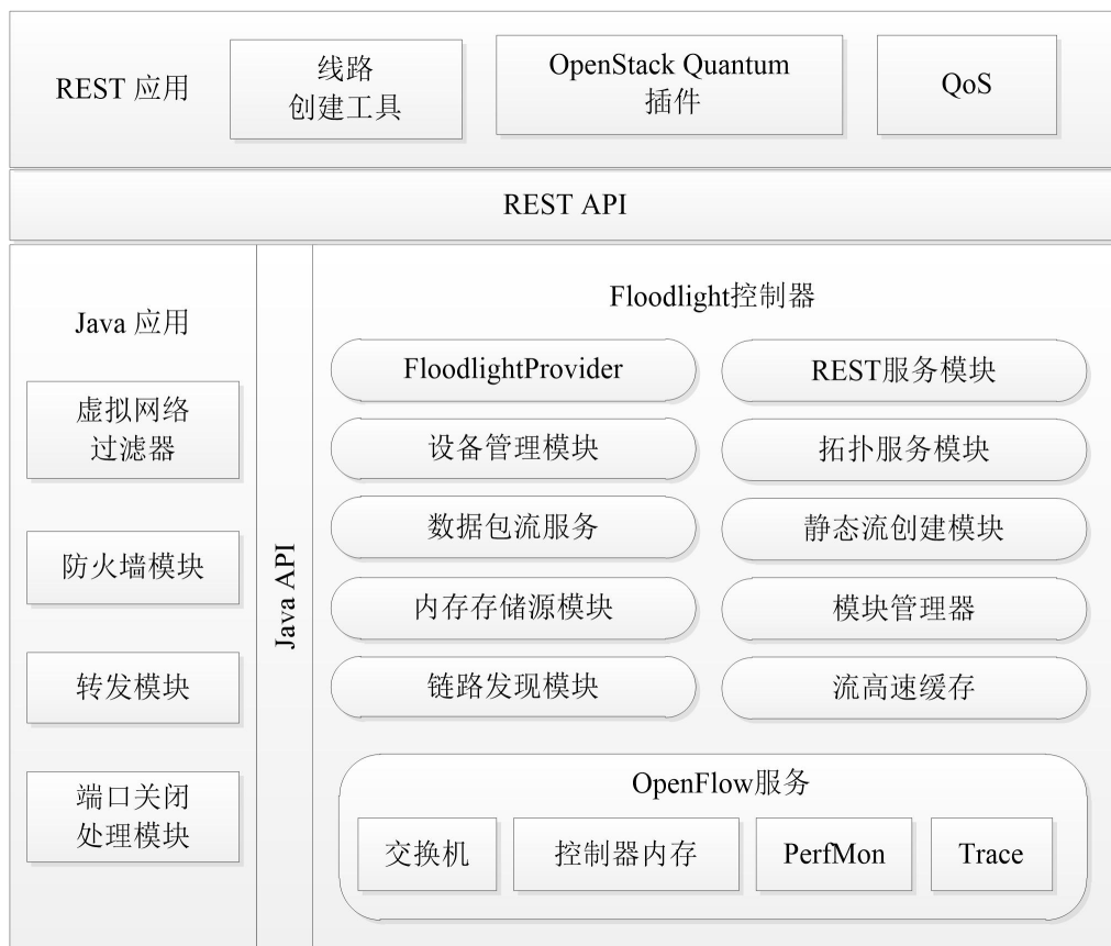
图 2.4 Floodlight 控制器架构
